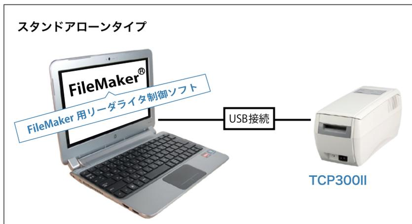
構成イメージ (FileMaker Pro がインストールされている PC へ TCP300II を接続して使用)
